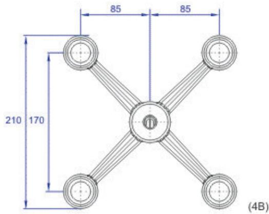
Araña AL-I de microfusión en acero inoxidable AISI-316 con acabado superficial pulido brillante o granallado y límite elástico mínimo de 210 Mpa. Mecanizado de alta precisión en centro de control numérico.
