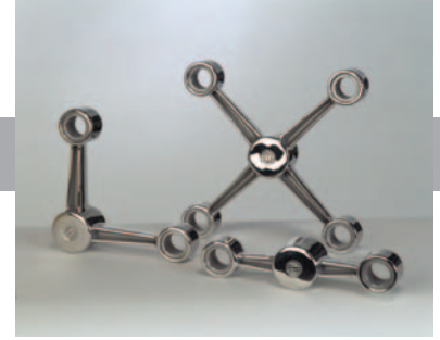
Araña AL-I de microfusión en acero inoxidable AISI-316 con acabado superficial pulido brillante y límite elástico mínimo de 210 Mpa. Mecanizado de alta precisión en centro de control numérico.
