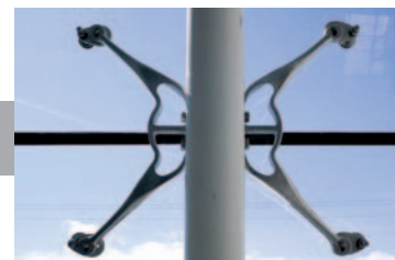
Araña WT-I de microfusión en acero inoxidable AISI-316 con acabado superficial satinado y límite elástico mínimo de 210 MPa. Mecanizado de alta precisión en centro de control numérico.
