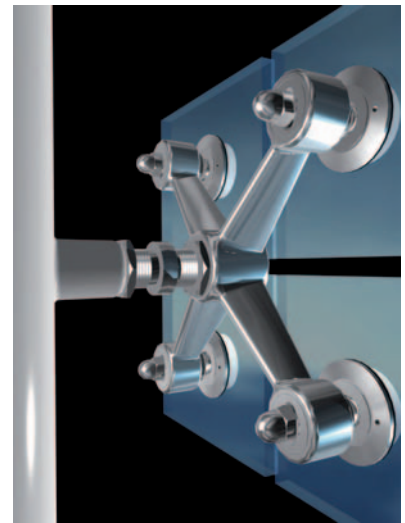
Araña AL-I de microfusión en acero inoxidable AISI-316 con acabado superficial pulido brillante y límite elástico mínimo de 210 Mpa. Mecanizado de alta precisión en centro de control numérico.
