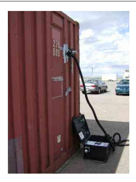
Coloque adecuadamente el aspirador, el tubo y el soporte de la cassette en la unidad de toma de muestra.
