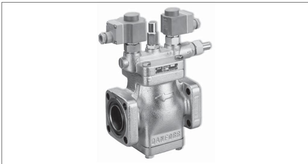
Las PMLX son válvulas principales servoaccionadas de dos tiempos, con válvulas piloto de solenoide roscadas. Las válvulas PMLX utilizan una fuente de presión externa para la apertura de la válvula sin necesidad de una diferencia de presión a través de la válvula.
