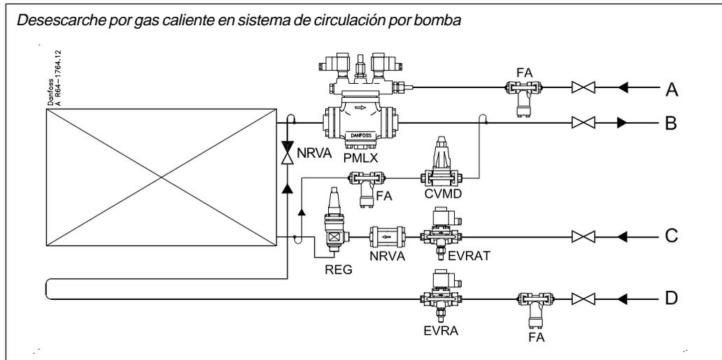
La figura muestra el lado de baja presión de una planta de R717 con evaporador inundado y circulación por bomba. En esta aplicación, la válvula de presión constante, tipo CVMD, se monta con regulador de presión en la línea de by pass entre el evaporador y la línea de aspiración húmeda después de la válvula solenoide, tipo PMLX.
