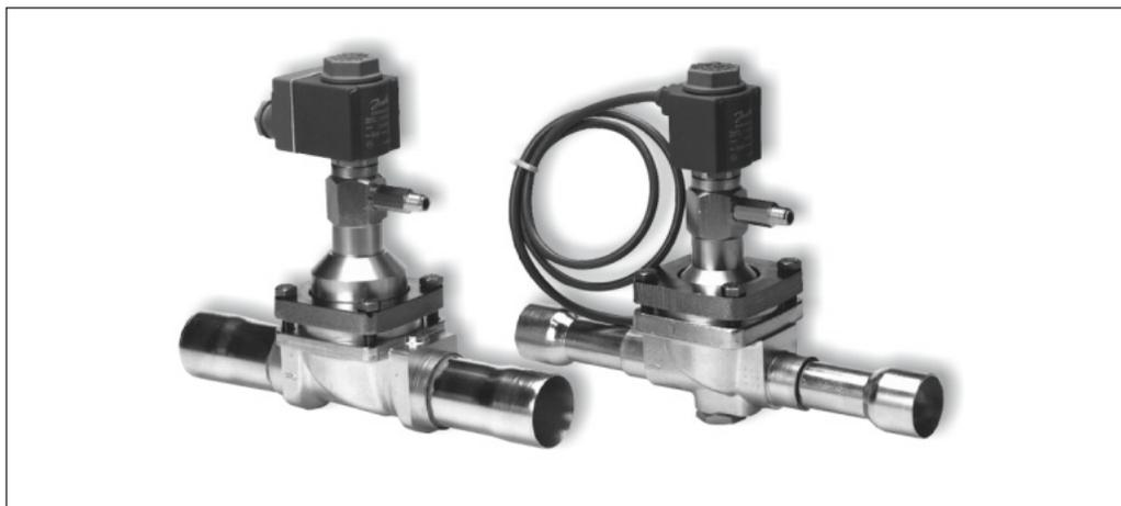
La PKVD es una válvula de solenoide que está abierta a una presión diferencial de 0 bar, lo que reduce el consumo de energía. La PKVD es del tipo NO (normalmente abierta), y se utiliza en las instalaciones frigoríficas de control tra-
