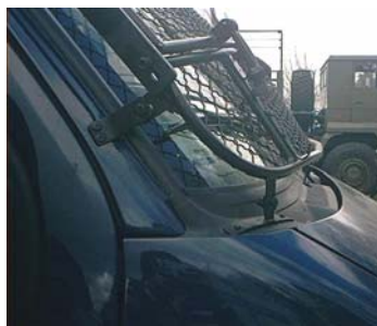
Rejilla abatible para protección de la luna delantera
