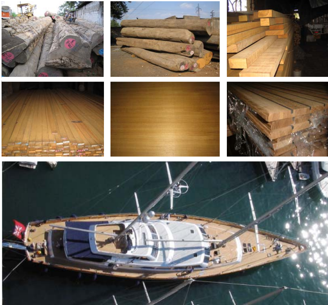
(Cubierta de Teca realizada por Futurnautic. Listones de 65x18mm. y de 5 a 6,5 metros de largo)
