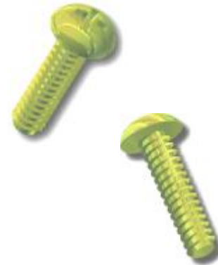
Tornillo de cabeza alomada con huella Ph2 Ø4 mm y longitud de caña de 16 mm para roscar en plástico.
