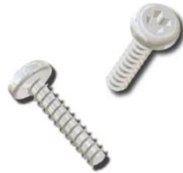
Tornillo con cabeza alomada con huella PZ1 Ø2.8 mm. y longitud de caña de 12 mm para roscar en plástico.
