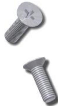
Tornillo avellanado, DIN7987 métrico M5 con huella Ph2 Ø9 mm. y longitud de caña de 16 mm. para roscar en aluminio.
