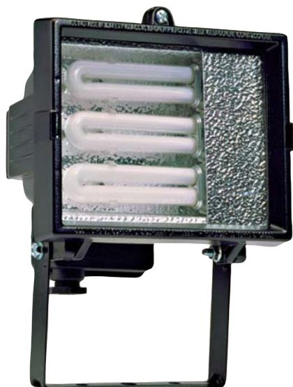
Estructura de aluminio pintada al horno con una base de resina poliéster. Reflector en aluminio puro, pulido y adonizado. Equipado con lámpara OSRAM DULUX de alta luminosidad y larga duración. Lente de cristal templado. Una junta de silicona nos asegura una excelente protección contra la filtración de agua y polvo.
