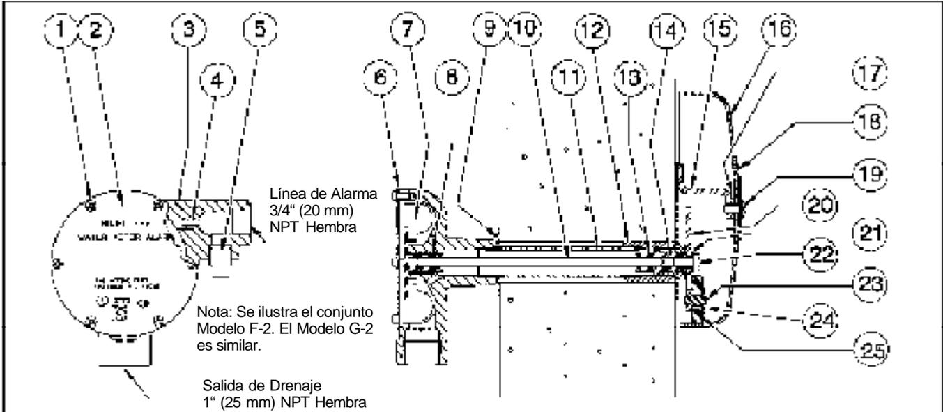
**Figura 1. Conjunto de Alarma Hidromecánica**
