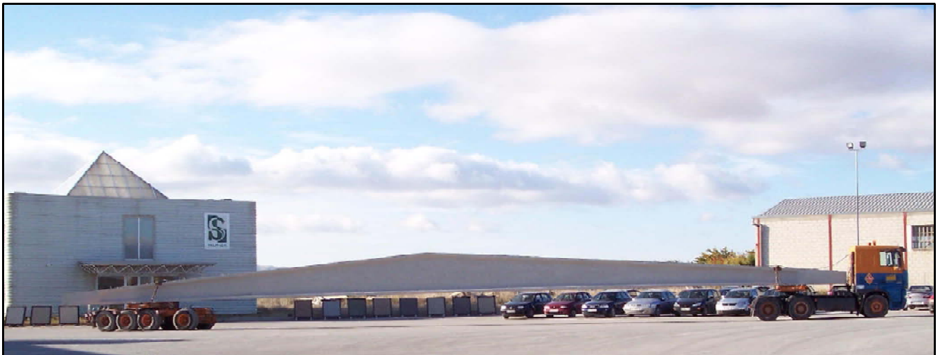
Transporte de vigas Delta del 7%.37,5m
