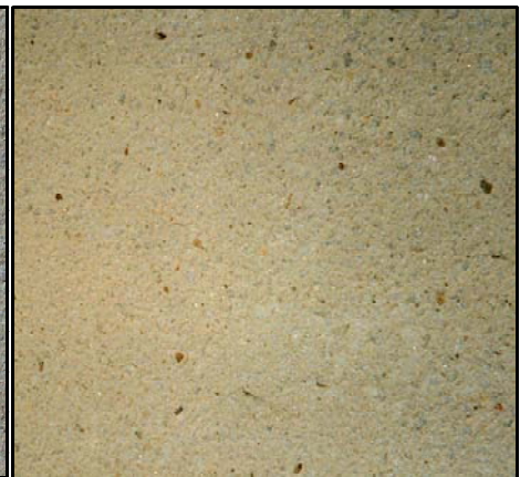
Acabado en Chorro de arena con arido Blanco y hormigón gris liso.
