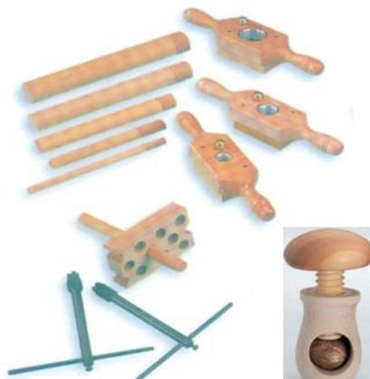
Consiste en un juego de macho y terraja para la realización de roscas interiores y exteriores en madera, para la construcción de prensas, juguetes, cascanueces, tornillos, etc. La caja de la terraja está fabricada en madera dura con una cuchilla cortadora de acero rápido en el interior, que podremos regular en su profundidad de salida. Disponible en varias medidas.
