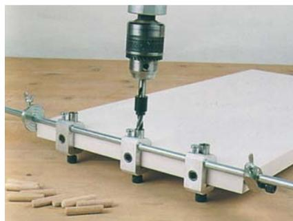
Plantilla metálica para la unión de tableros de 16 y 19 mm mediante espigas de 8 mm o tornillos de ensamblar. Se trata de una varilla metálica redonda de 660 mm de longitud sobre la que se desplazan 3 topes de taladrado regulables en función de dónde se realicen los taladros y dos topes de fijación del ancho de nuestra pieza. La plantilla viene preparada para el tablero de 19 mm de
