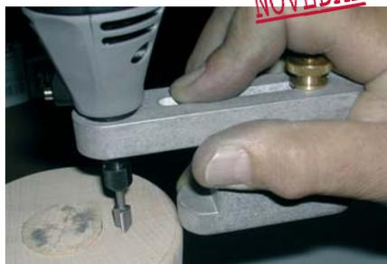
Sencillo dispositivo fabricado en aluminio para hacer ranuras o rebajos paralelos a los bordes en piezas curvas con la máquina puesta en posición vertical. Incluye una pieza corredera para el ajuste de la profundidad de entrada en el fresado. Ideal para la realización de fresados paralelos al canto de las tapas del instrumento.
