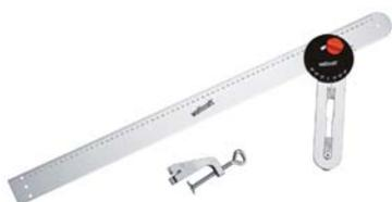
Se trata de una regla de aluminio ligera de 750 mm de longitud y una pieza plástica que sujeta esta regla con una palomilla a otra pieza con la que fijaremos el ángulo que deseemos. Goniómetro para la regulación de ángulos de 15 en 15° (0, 15, 30, 45°) y un ángulo recto de 90° fijo. Regla con escala milimétrica. Podemos usarla para trazados en piezas grandes o para utilizarse como
