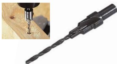
Avellanador de HSS para brocas de mango hasta 3,2 mm. Punta a 90° con la broca en medio y diámetro máximo de avellanado de 12 mm. Incluye llave allen para la fijación de la broca al cabezal de avellanado.
