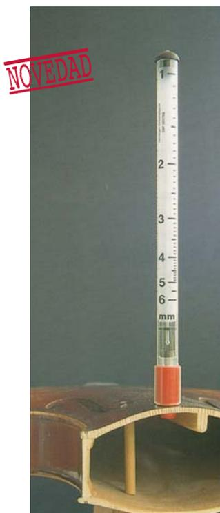
El único medidor de espesores que nos permite medir el espesor de las tapas de un instrumento sin desmontarlo. El imán se introduce por la boca del instrumento y se
