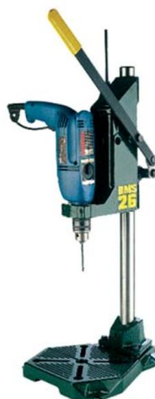
Probablemente sea el soporte de columna más robusto del mercado, fabricado en fundición de acero todos sus componentes hasta incluso la columna, pesa entorno a los 19 kgs. y es válido para todos los taladros con cuello de 43 mm. Cómoda palanca para la bajada del cabezal. Regulación del tope de profundidad con un tornillo. Fijación del cuerpo del cabezal a la columna con una palomilla de gran tamaño.
