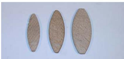
Es esta la galleta o pastilla ensambladora original del fabricante suizo LAMELLO, inventor del sistema de ensamblaje por galletas. Fabricada en madera de haya prensada para que al contacto con la cola se infle y consigamos así un robusto ensamble.
