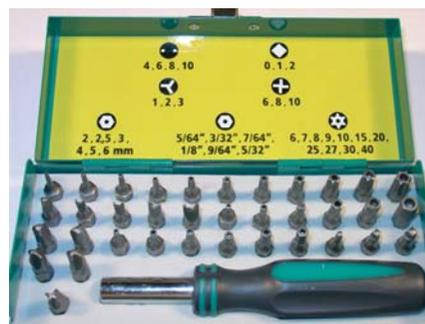
Caja metálica con 36 puntas de 7 cabezas diferentes y varias medidas de cada una para tornillos raros de máquinas portátiles, pequeños electrodomésticos, electrónica y automoción. Incluye un mango de destornillador con inserción hexagonal para el montaje de estas puntas.
