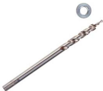
Broca escalonada de 180 mm de longitud total, 97 mm de corte con un primer tramo de 4,4 mm de diámetro para realizar el agujero que servirá para el diámetro del tornillo, y un segundo tramo de 9,5 mm de diámetro, igual que el mango, para realizar el
