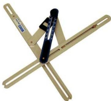
También fabricada por el sueco NOBEX, esta ya clásica herramienta mide cualquier esquina y traslada el ángulo correcto a su sierra de mesa o ingleteadora. La escuadra Multifix le dará el ángulo exacto de cualquier esquina, externa o interna, y la convertirá en el ángulo de corte que necesita con gran precisión.
