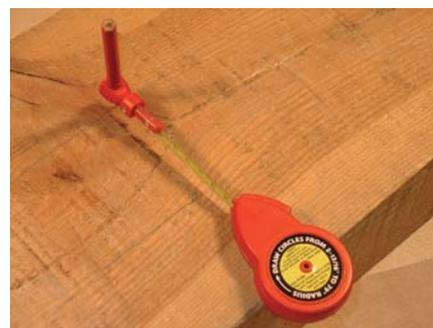
arcos o para la medición de los mismos. En la parte inferior de la caja lleva una pequeña solapa plástica que nos servirá de apoyo para realizar trazados apoyándonos en una cara plana y usarse así como un gramil marcador con lectura de medida con lapicero.
