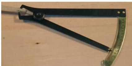
Sencillo aparato analógico para mediciones rápidas de espesores fabricado en acero pintado de negro, con el eje y escala de medida en latón.
