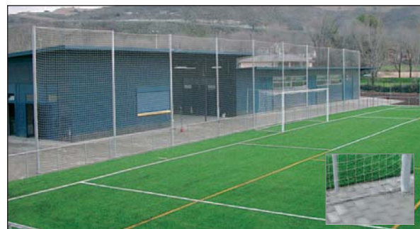
FA/60001 UNIDAD DE POSTE DE DIÁMETRO 100 MM. Galvanizado Altura 5,30 m + 0,70 m de anclaje.
