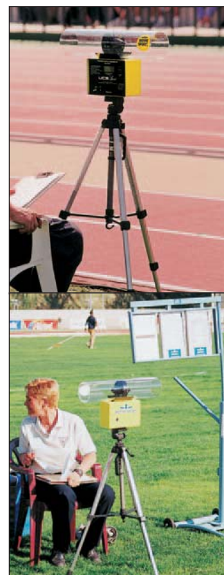
J/00351 ANEMÓMETRO DIGITAL UCS/SPIRIT. Reglamentario I.A.A.F. Se suministra con trípode y maleta para transporte y conservación.
