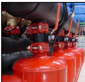
Posibilidad de control del caudal en hidrociclón mediante válvulas en Equipos de Filtrado
