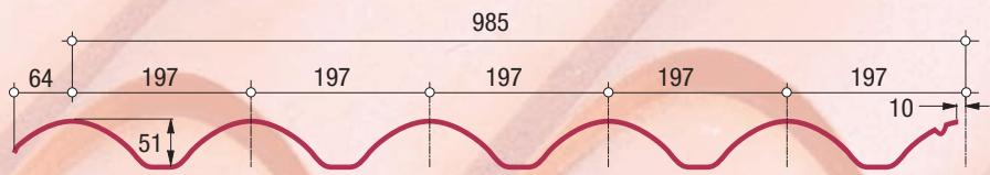
La placa del **Sistema Coppo** tiene una notable rigidez debida a la nervadura del perfil, disminuyendo la deformación por sobrecargas (nieve, tránsito...)
