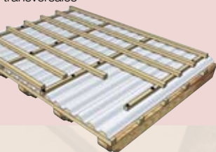
Colocación de rastreles transversales
