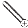
Tornillo avellanado M 6 para manilla 9-13274-50-0-1 (L= 50 mm) 9-13274-60-0-1 (L= 60 mm) 9-13274-75-0-1 (L= 75 mm) 9-13274-80-0-1 (L= 80 mm)
