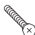
Accionamiento interior y exterior Tornillo avellanado M5x25 9-13255-25 M5x30 9-13255-30 M5x35 9-13255-35 M5x40 9-13255-40 M5x45 9-13255-45 M5x60 9-13255-60 (FD 56-60) M5x70 9-13255-70 (FD 61-70) M5x80 9-13255-80 (FD 71-80)
