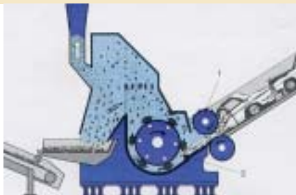
Esquema de una trituradora de coches
