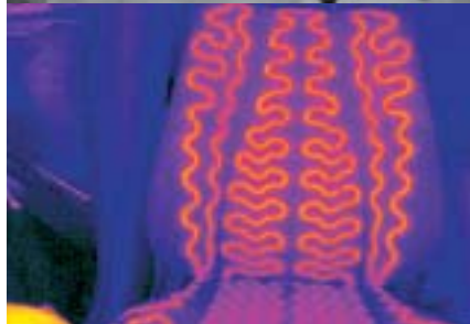
Asiento acabado, incluyendo la calefacción, controlado con ayuda de una cámara termográfica
