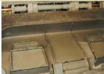
Molde satinado con puntales antes de llenar con espuma. Los puntales son difíciles de detectar
