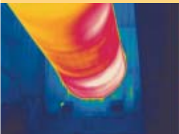
Rotura del refractante en hornos de cemento giratorios
