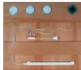
Lámparas completamente montadas, interruptores y cable de alimentación con distribuidor HV de 6 contactos (+ 1 codificado).
