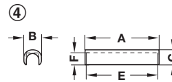
④ Portaetiquetas insertables: plástico transparente para fijar insertando en tiradores redondos de 10 mm, orientable a la vista
