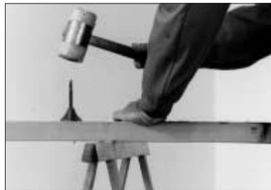
2. Clavar por debajo el tornillo con el apoyo montado
