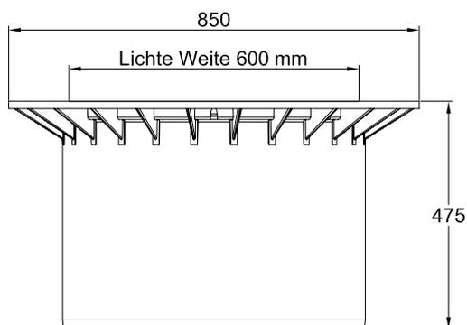
Cubierta telescópica CARAT de hierro colado , transitable por coche
