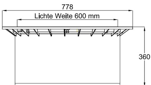
Cubierta telescópica CARAT MINI con tapa de PE, transitable
