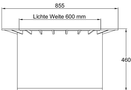
Cubierta telescópica CARAT de hierro colado y hormigón , transitable por camión
