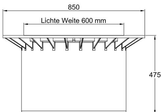
Cubierta telescópica CARAT MAXI con tapa de PE, transitable
