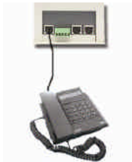
Fig.5. Programación GSM-10/20 en modo local
