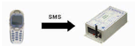
Fig.7. Programación de GSM-10/20 mediante mensajes SMS
