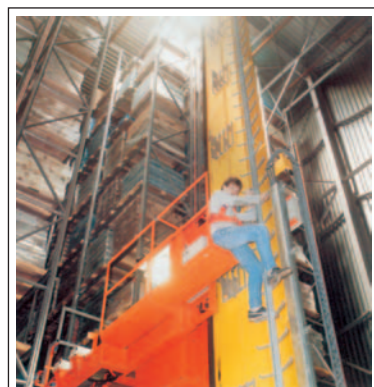
Protección de ascensión en una instalación de estanterías elevadas.
