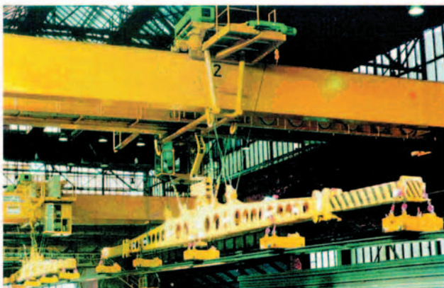
Puente grúa pesado en la industria siderúrgica
