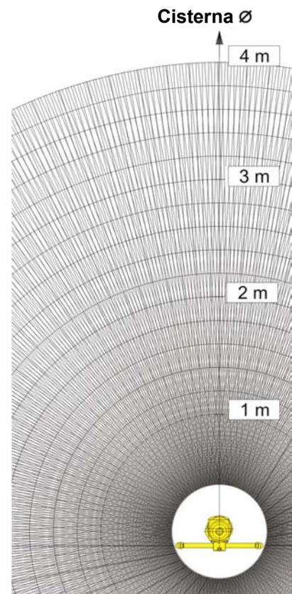
Gráfico de chorro de un limpiador de cisternas Aquamat® con un brazo de rotor, al cabo de 260 revoluciones completas del brazo.
