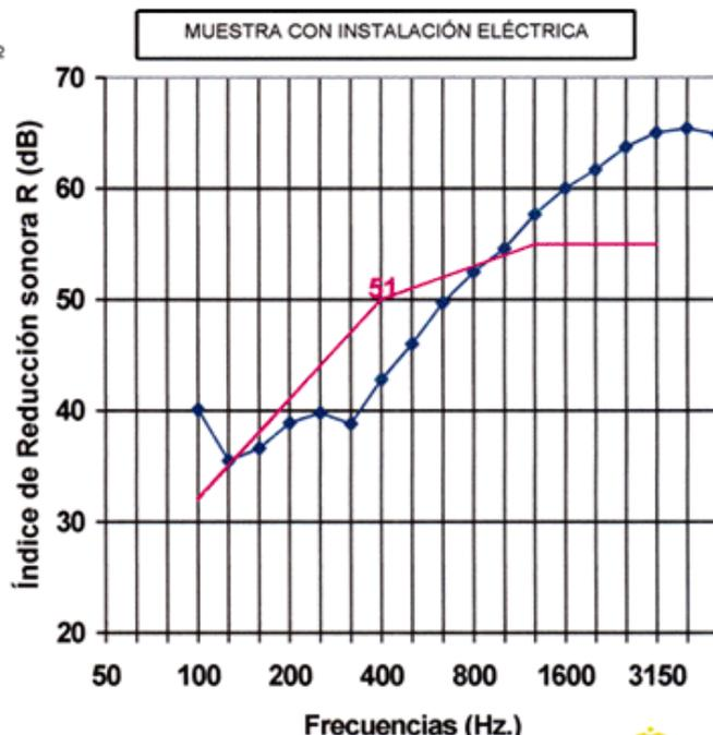
Indices de aislamiento: UNE-EN ISO 717-1:1997  $R_w(C;C_{tr})$ : 51 (-2 ; -5) dB
