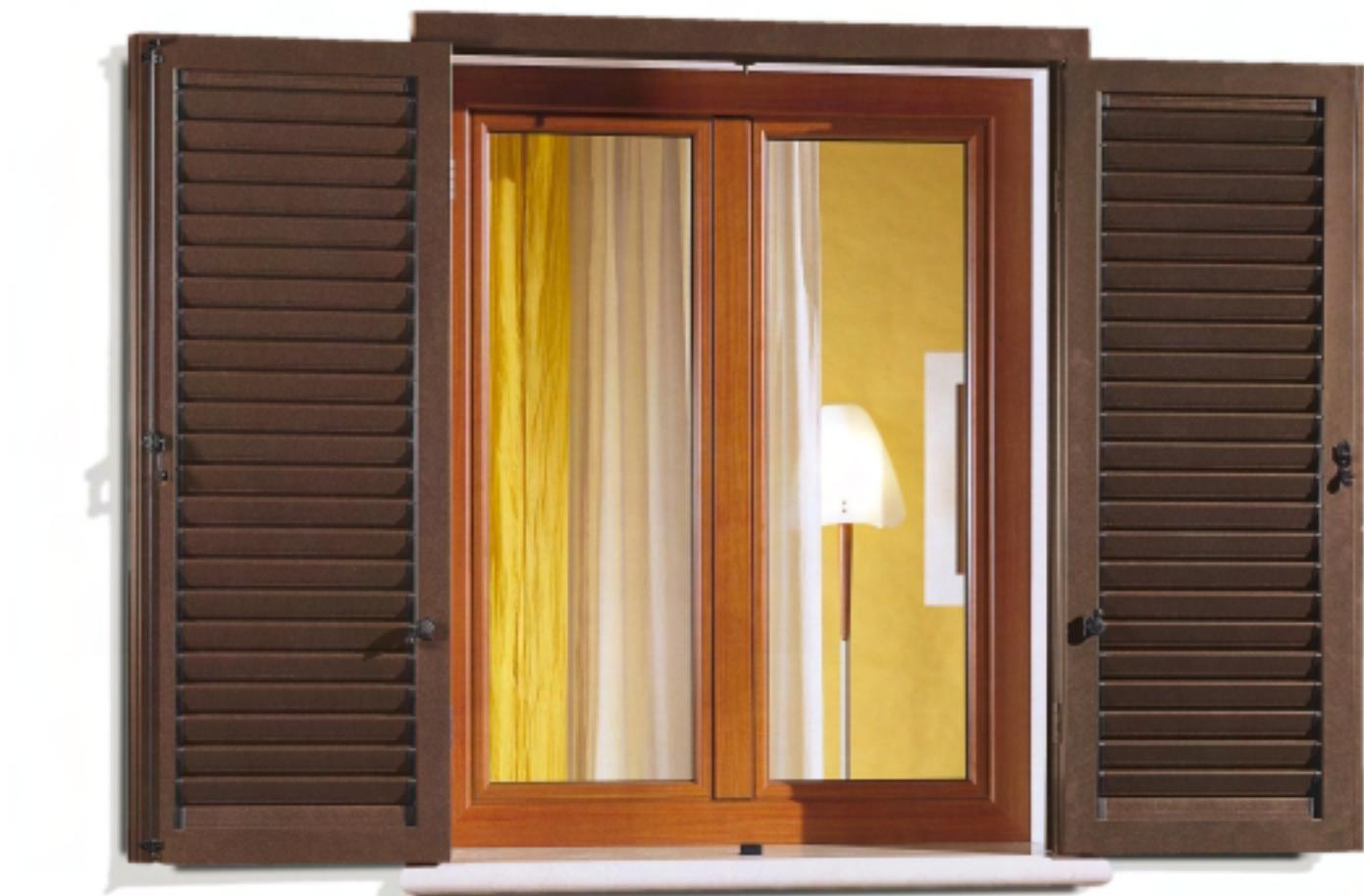
F Persienne en aluminium de 45 mm avec angles soudés, de 31 mm avec angles assemblés mécaniquement et lamelles orientables de 55 mm. Cette persienne avec des lamelles en forme de gouttes orientables permet de doser d'une façon optimale la lumière et la ventilation. Le réglage dans la position voulue est effectué à l'aide d'une poignée pivotante autobloquante.
