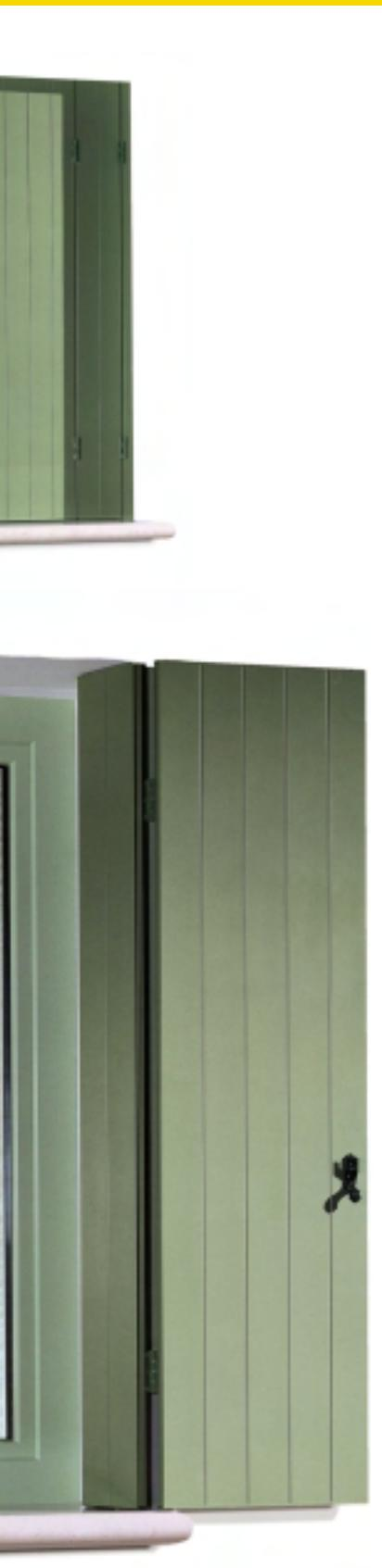
D Fensterblende in Aluminium 25 mm mit gesickten Ecken, mit selbst tragenden Dauben von innen belüftet. Die Breite der Flügel wird zusammengesetzt durch die Nutzung verfügbarer Profile in verschiedenen Schnitten. Die Öffnung nach "Paduanischer" Art sieht die Faltung der Flügel nach außen vor.
