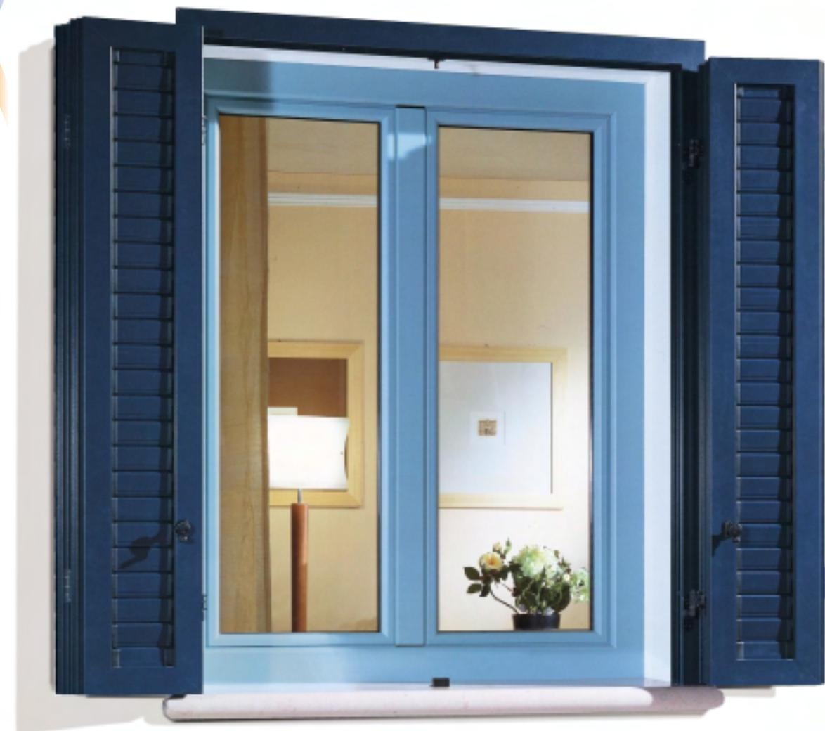
F Volet en aluminium de 45 mm avec angles soudés, de 31 mm avec angles assemblés mécaniquement, les battants sont réalisés avec des panneaux moulurés isolés et lamelles orientables de 55 mm, les lamelles en forme de gouttes orientables permettent de doser d'une façon optimale la lumière et la ventilation. Le réglage dans la position voulue est effectué à l'aide d'une poignée pivotante autobloquante.
