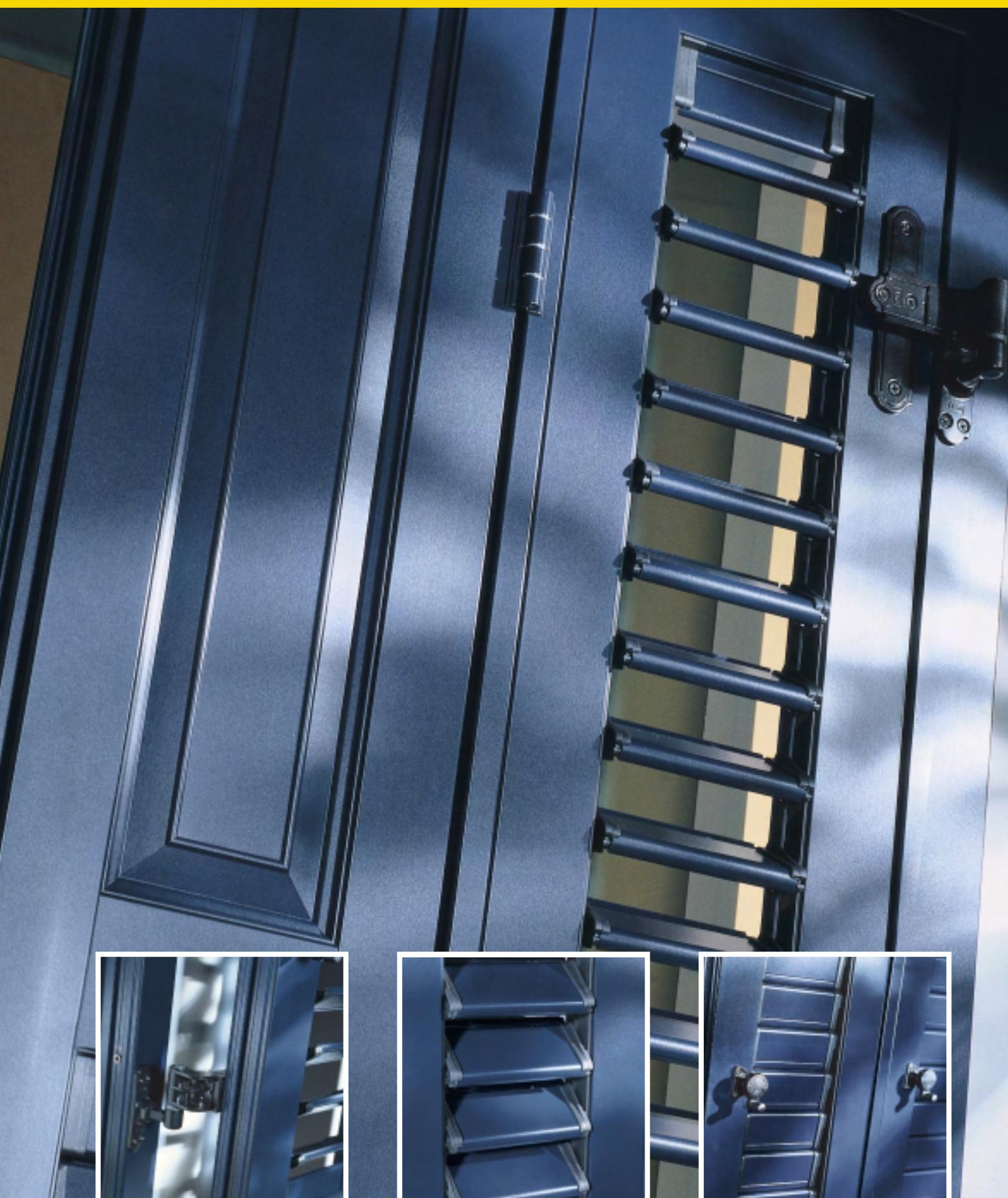
I Persiana in alluminio da 45 mm con angoli saldati, da 31 mm con angoli assemblati meccanicamente, le ante sono realizzate con pannelli diamantati cobentati e lamelle orientabili da 55 mm, le lamelle a forma di goccia orientabile consentono di dosare in modo ottimale la luce e la ventilazione. La regolazione nella posizione desiderata, avviene tramite un pomello girevole auto bloccante.
