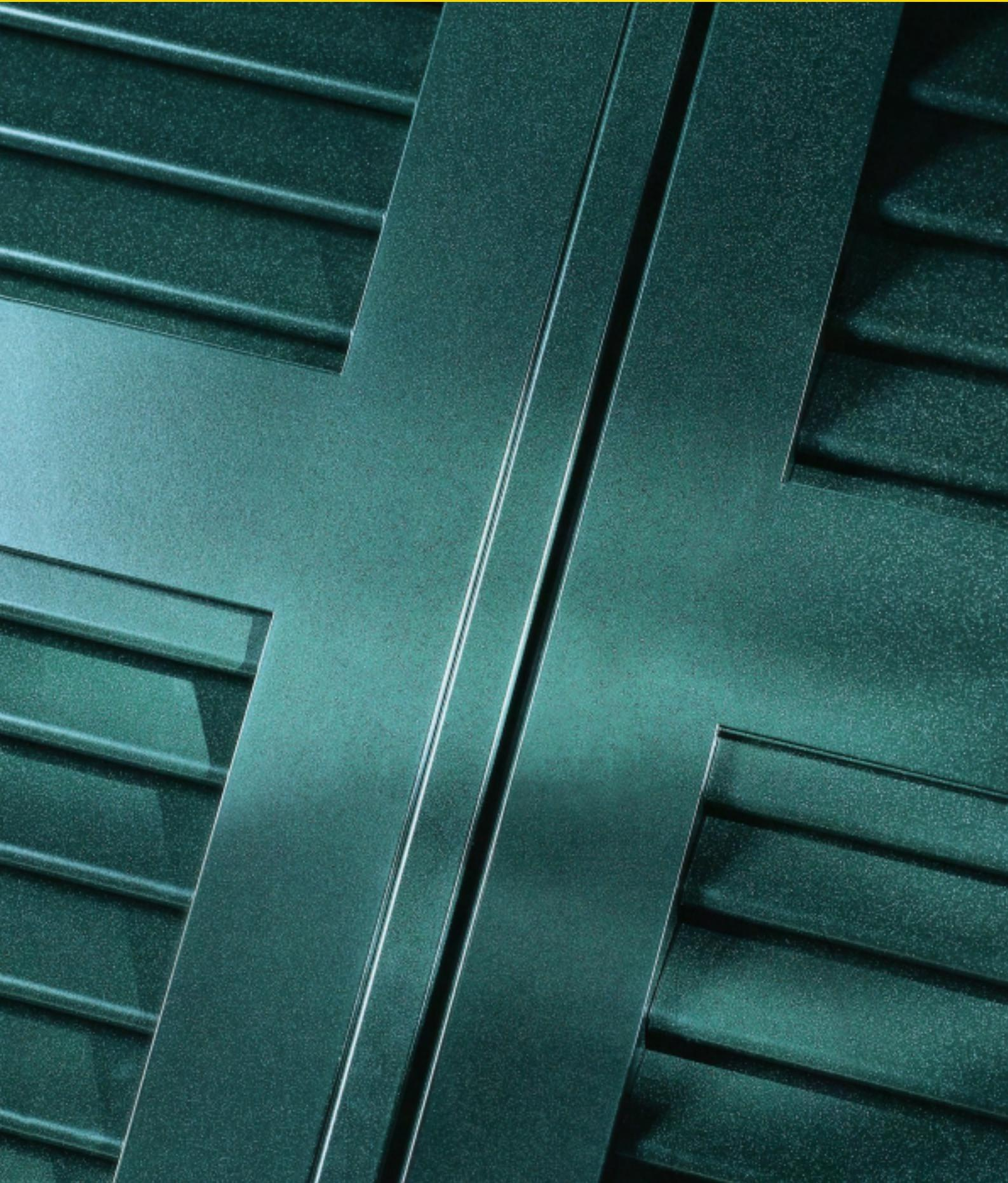
**F** Persiana en aluminium de 45 mm, avec angles soudés, de 31 mm avec angles assemblés mécaniquement et lamelles ovales fixes de 10x50mm espacées de 40 mm. La lamelle fixe espacée de forme ovale arrondie, permet un éclairage modéré et une ventilation efficace.
