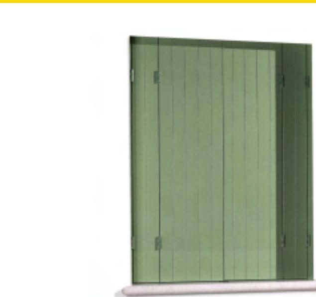
E Contraventana de 25 mms. en aluminio con ángulos ensamblados mecánicamente, con duela autosustentadoras ventiladas en el interior. La anchura de las hojas se realiza utilizando perfiles con secciones diferentes. La apertura a la "Paduana" prevé la replegadura de las hojas al exterior.
