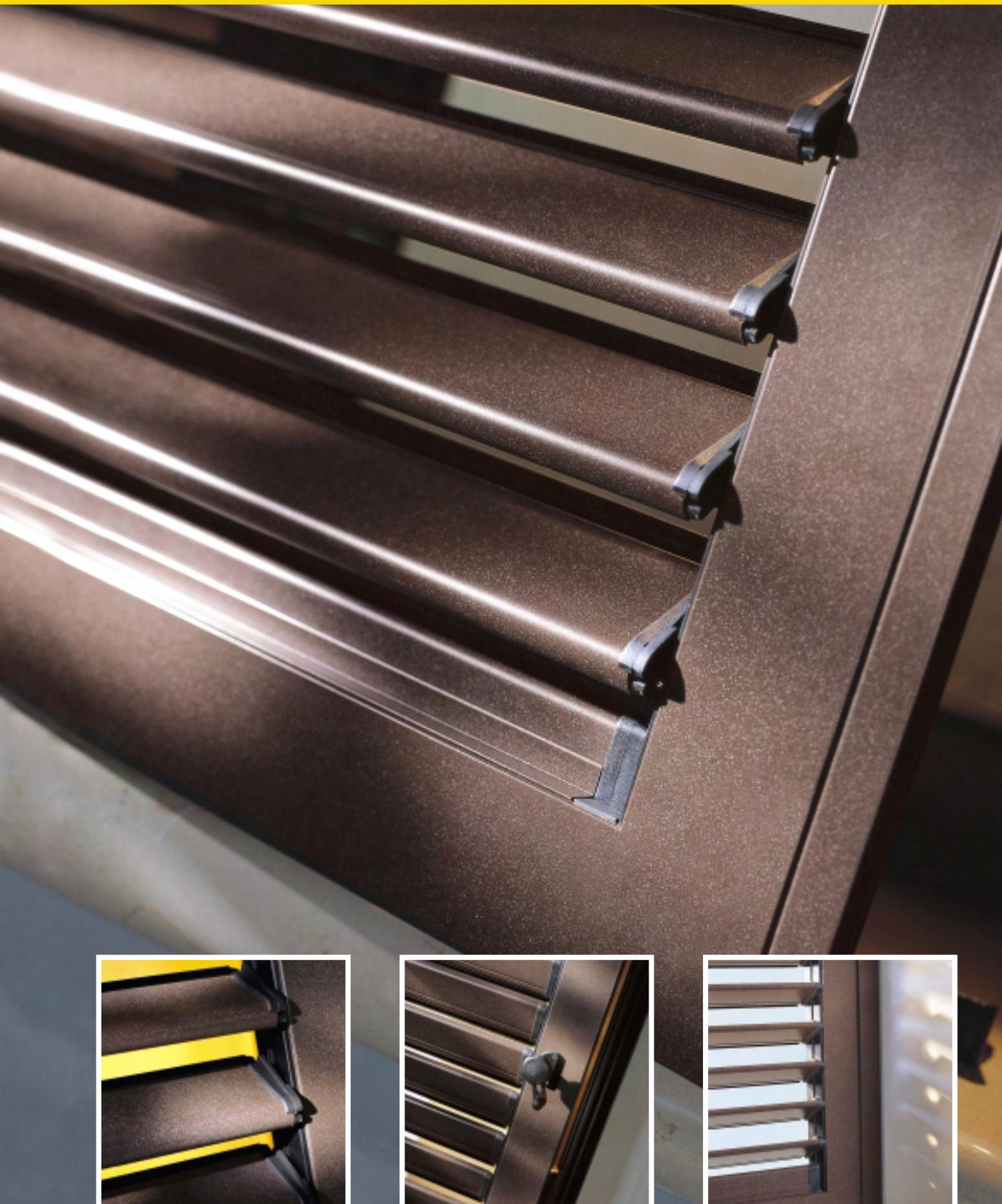
I Persiana in alluminio da 45 mm con angoli saldati, da 31 mm con angoli assemblati meccanicamente, e lamelle orientabili da 55mm. Questa persiana con lamella a forma di goccia orientabile consente di dosare in modo ottimale la luce e la ventilazione. La regolazione nella posizione desiderata, avviene tramite un pomello girevole auto bloccante.
