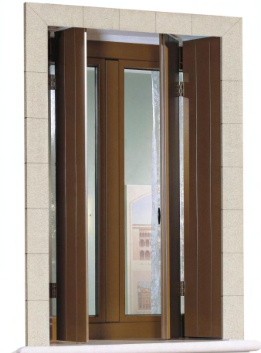
[E] Contraventana de 25 mms. en aluminio con ángulos ensamblados mecánicamente, con duelas autosustentadoras ventiladas en el interior. La anchura de las hojas se realiza utilizando perfiles con secciones diferentes. La apertura a la "Vicentina" prevé la replegadura de las hojas en el interior de un nicho de la jamba externa, de forma que queden ocultadas en posición abierta.
