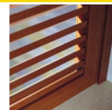
F Persienne en aluminium de 45 mm avec angles soudés et lames rhomboïdales de 14 x 35 mm distancées de 40 mm. Cette persienne est utilisée dans les palais historiques du centre de l'Italie, leur origine remonte au XIV è siècle. La ligne rigoureuse et noble la rendent fascinante et immuable dans le temps.
