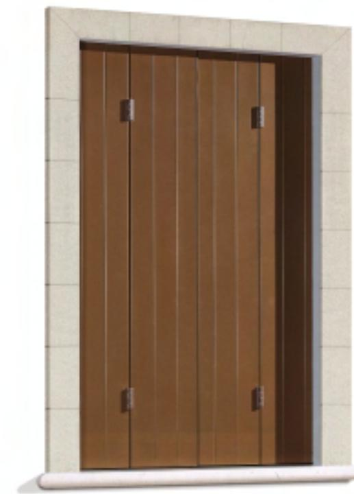
[F] Volet en aluminium de 25 mm avec angles assemblés mécaniquement avec lattes autoportantes ventilées à l'intérieur. La largeur des battants se compose des profils disponibles dans les différentes sections. L'ouverture en accordéon prévoit de rabattre les battants à l'intérieur d'une niche du montant extérieur de la fenêtre qui permet ainsi de les cacher en position ouverte.
