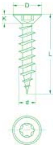
CABEZA PLANA TOR EST ROSCA MADERA UN HILO 40° TX COUNTERSUNK HEAD CHIPBOARD SCREW VIS A BOIS AGLOMERÉE FILET 40° TÊTE FRAISÉE TX
