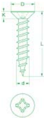
CABEZA PLANA PHILIPS ROSCA MADERA DOBLE HILO PHILIPS COUNTERSUNK HEAD DOUBLE THREAD WOOD SCREW VIS A BOIS A DEUX FILETS TÊTE FRAISÉE PHILIPS
