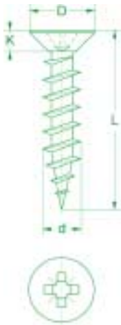
CABEZA PLANA POZI ROSCA MADERA UN HILO 40° POZI COUNTERSUNK HEAD CHIPBOARD SCREW VIS A BOIS AGLOMERÉE FILET 40° TÊTE FRAISÉE POZI
