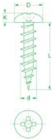
CABEZA ALOMADA POZI ROSCA MADERA UN HILO 40° POZI PAN HEAD CHIPBOARD SCREW VIS A BOIS AGLOMERÉE 40° TÊTE CYLINDRIQUE BOMBÉE POZI
