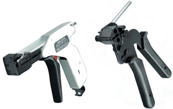
WSM-Tool es una herramienta para apretar las bridas de acero. Hay disponibles dos modelos diferentes: Con el modelo "automático" es posible apretar las bridas y seguidamente se corta el extremo de la brida sobrante en un solo paso de trabajo.
