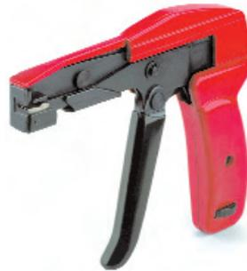
RT 1 es una herramienta compacta en forma de pistola con la que el usuario puede apretar y cortar bridas en un solo paso de trabajo. La fuerza de sujeción puede ajustarse dentro de un rango muy amplio que va desde bridas pequeños hasta bridas estándar. RT 1 puede emplearse para bridas de entre 1,6 mm a 100 mm de diámetro.
