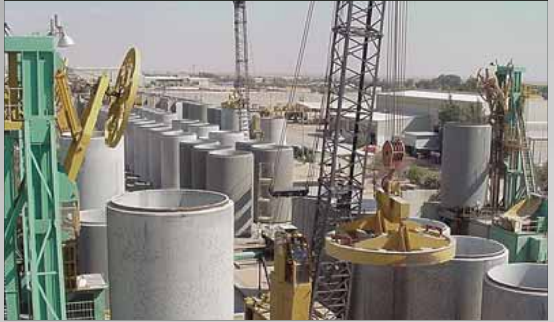
Tuberías pretensadas para conducción de líquidos · Prestressed concrete pipes for the transportation of liquids.
