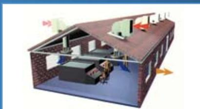
Unidades adecuadas para la instalación en sobrepresión. Se montan sobre la cubierta del recinto, introduciendo verticalmente el aire refrigerado. Cada unidad incorpora su propio equipo motoventilador.
