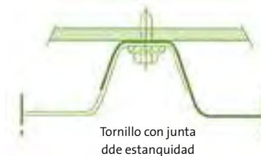
Tornillo con junta de estanquidad
