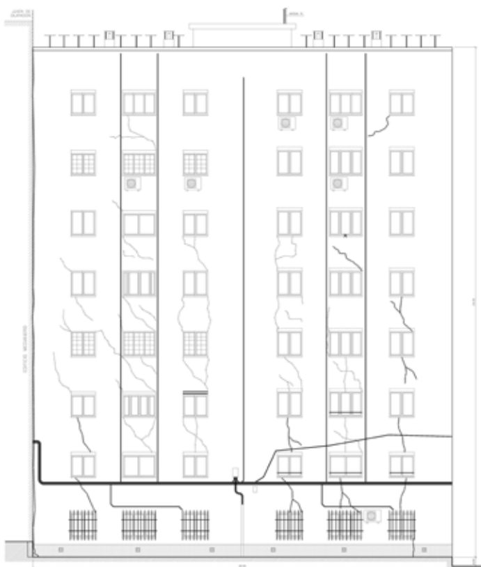
Figura 3: Implantación y realización de ensayos E.R.T. 3D diagnóstico.
