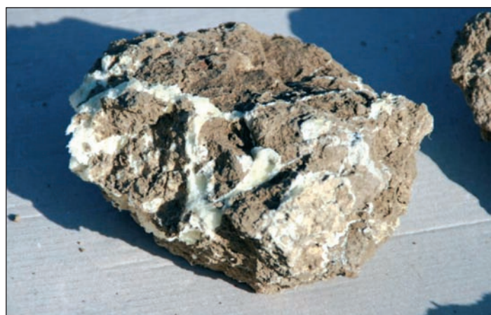
[Figura 7].- Muestra de terreno consolidado con resina expansiva.
