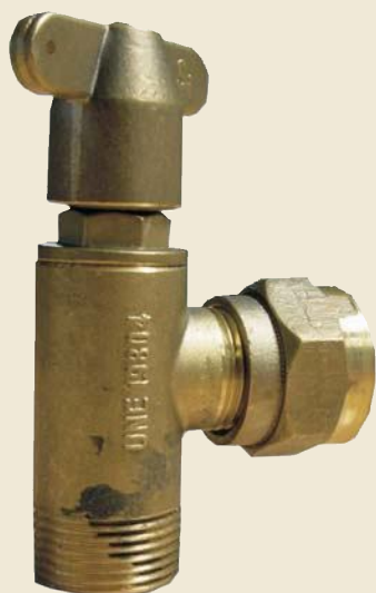
REF. VASA Disponible DN 13 RACOR 3/4", ROSCA M. 3/4, con antifraude, polietileno 25 ó 32 m/m.
