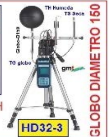
medición PMV y PPD según ISO 7730
