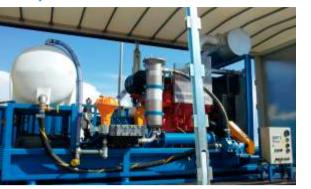
Limpeza por hidrojateamento com veículos equipados com bombas de alta pressão (até 1200 bar). Ideal para indústria petroquímica, química, siderúrgica, alimentícia, offshore, etc.
