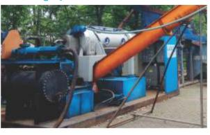
Unidades móveis de centrifuaação que permitem fazer a remoção e adensamento de lodo e sedimentos, no próprio local, sem necessidade de obra estrutural.
