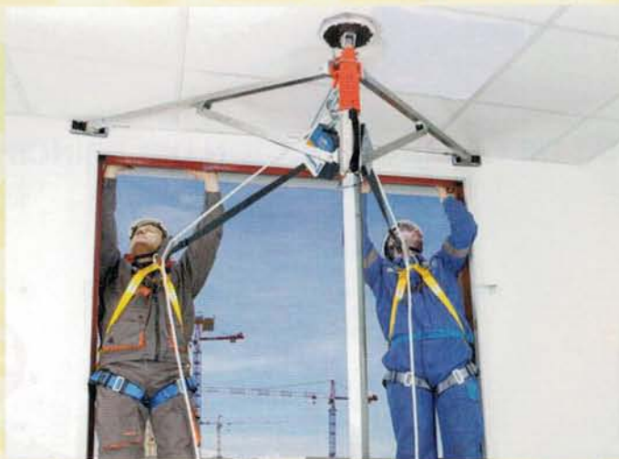
Compuesto por tres brazos, el SYAM se apoya en los paramentos verticales. Asegura al operario mediante cuerdas y/o cintas.
