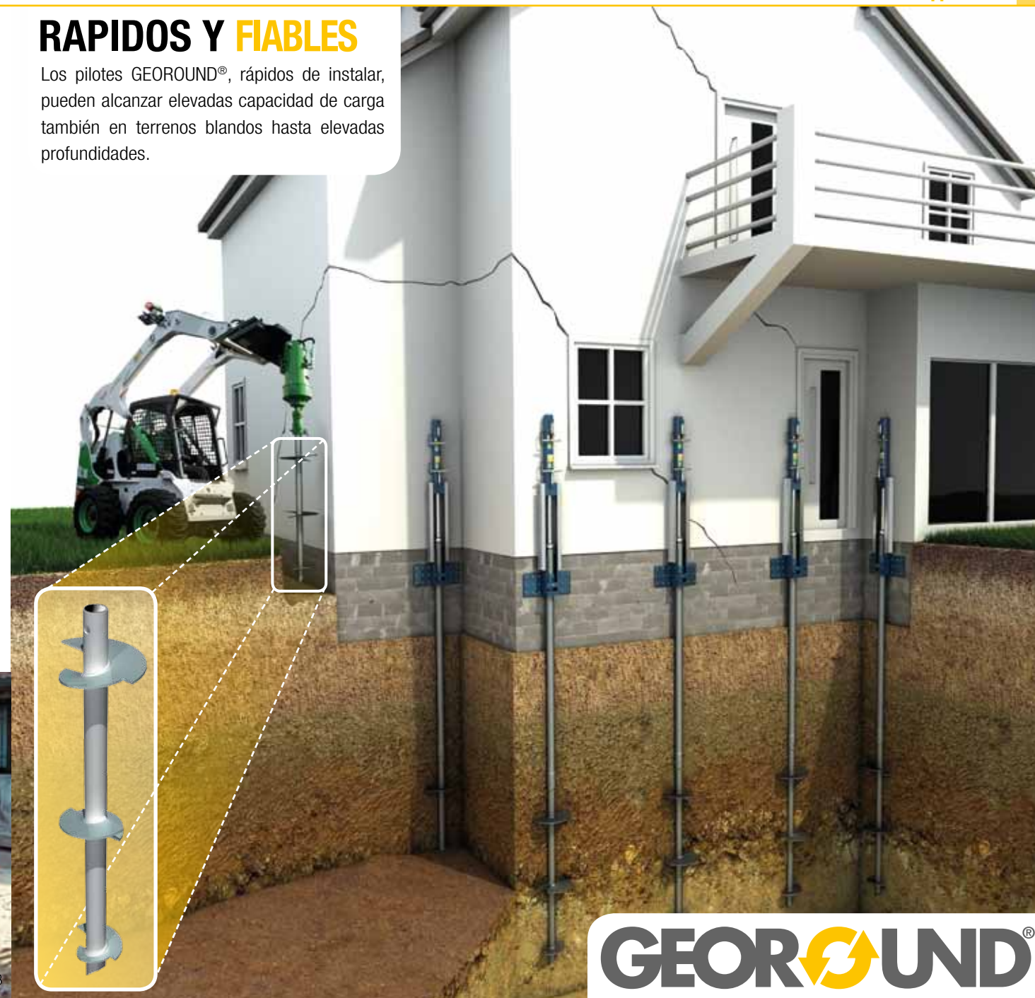
FASE DE INSERCIÓN DEL PILOTE PARA NUEVAS CONSTRUCCIONES
