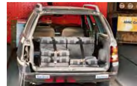
2009: Crash test con el suelo Carmo y L-BOXX con los asientos traseros abatidos a 50 km/h homologado por ADAC.
