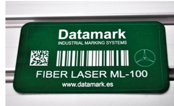
Marcado de placas de identificación
