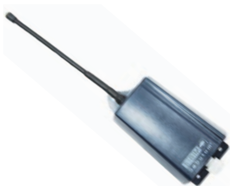
SRC 12/24 Receptor autónomo 1 canal 255 códigos 12 y 24 V.
