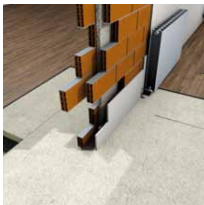
Aislamiento ruido impacto en suelo flotante
