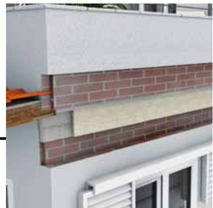
Corrección puente térmico frente forjado
