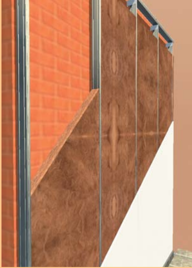
Trasdosado autoportante con Panel Plus (TP 138)
