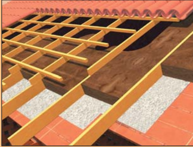
Cubierta inclinada con Panel Plus (TP 138)
