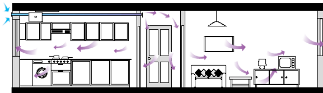
Si la vivienda no dispone de loft, existe un equipo mural
